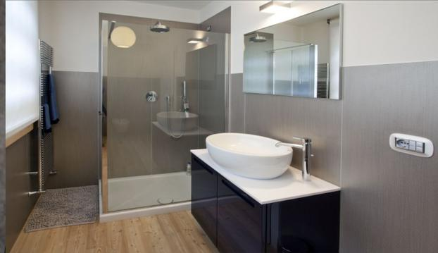
LAMINAM® hebt sich von herkömmlicher Keramik deutlich ab und wirft die bisherigen abmessungs- und gewichtsbezogenen Grenzen der Porzellankeramik über Bord. Die hoch verdichtete und homogene Porzellanoberfläche wird als 1000 x 3000 mm große Platte mit einer Stärke von 3 mm produziert. Der besondere Clou ist das Gewicht: LAMINAM® ist die weltweit erste Keramikplatte dieser Größe mit einem geringeren spezifischen Gewicht als Aluminium.
